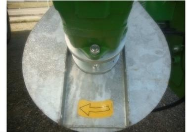
Un palier intermédiaire est monté sur le moteur hydraulique. Celui-ci permet de préserver l'état du moteur hydraulique en supprimant les contacts du lisier avec son arbre.
