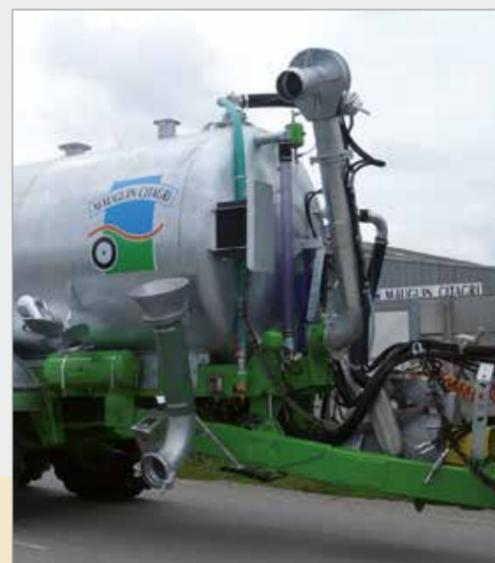
Flèche hydraulique et compresseur industriel 15 000 L refroidi à eau
