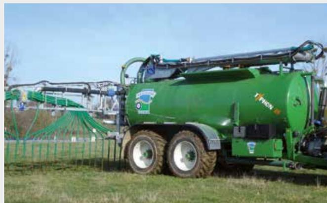
TYPHON 21 avec rampe pendillards 18 mètres
