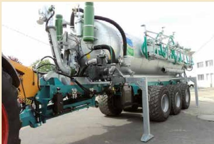
Équipement 22 000 L avec rampe 24 mètres sur châssis ROLLAND
