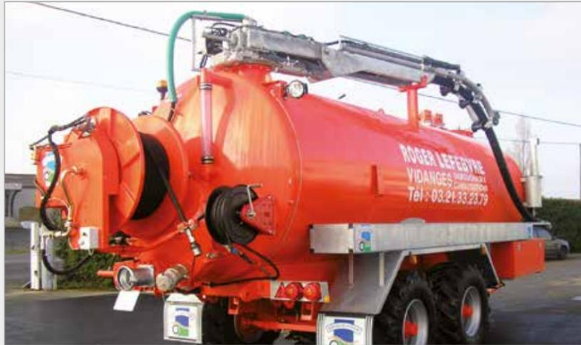
Hydrocureuse 18 500 L avec tourelle de pompage à rotation par entraînement hydraulique. Tourelle télescopique avec tuyau de Ø 100 mm. Deux compartiments dont un pour l'eau propre et l'autre pour le stockage et l'évacuation des boues.
