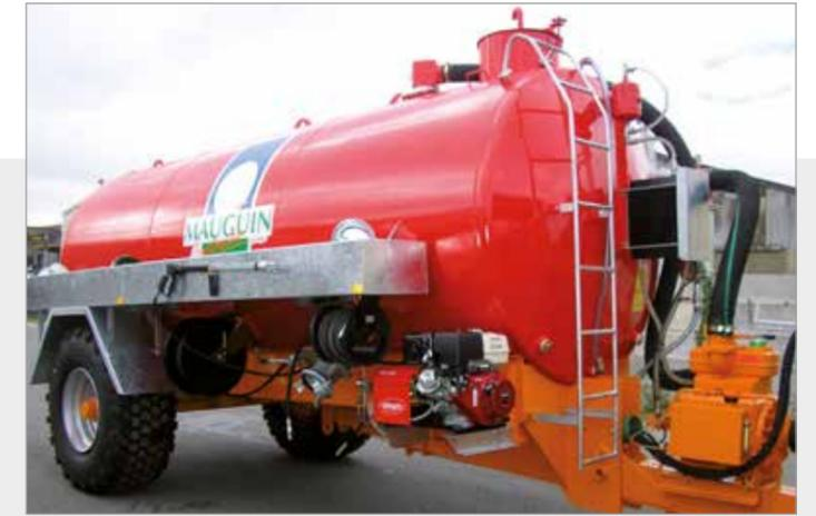
Hydrocureuse 10 800 L avec groupe de nettoyage HP 18 l/min
