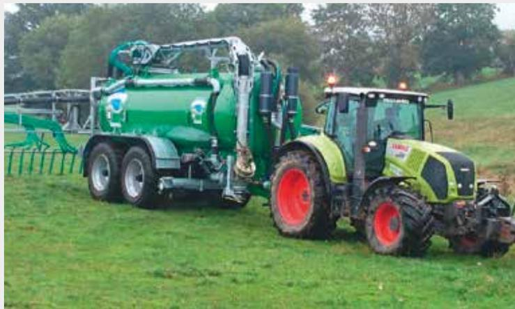
Tonne 21000 litres hybride avec rampe pendillards 18 metres
