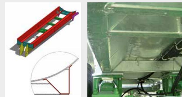
**La gamme TORNADE est équipée du châssis autoporteur monocoque.** Il permet d'absorber les efforts du train roulant et le montage d'équipement arrière. Cette gamme se caractérise par son train roulant tandem et se décline en 2 modèles, de 18 000 L et 20 000 L. L'essieu tandem permet un montage de roues de plus grand diamètre par rapport au système boggie et une meilleure stabilité de l'ensemble roulant. Le confort et la sécurité sont donc accrus.
