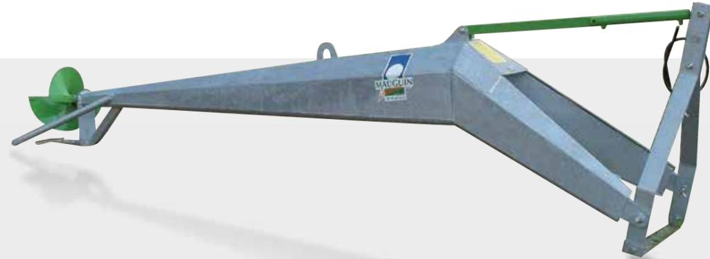
Munis d'une vis de Ø 600 mm et d'un axe de 60 mm, les broyeurs MAUGUIN CITAGRI sont conçus pour brasser et homogénéiser les lisiers denses et pailleux. Un tube de protection assure la sécurité autour de l'hélice et évitera tout problème dans les fonds de fosse.
