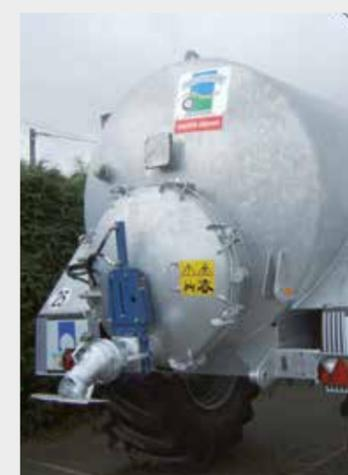
Porte arrière de Ø 950 mm avec 8 fermetures, vanne inox de type industriel fonctionnant en double effet et buse Ras le sol. Modèle équipé de l'option chapes arrières permettant l'installation d'un équipement arrière de type rampe ou enfouisseur.
