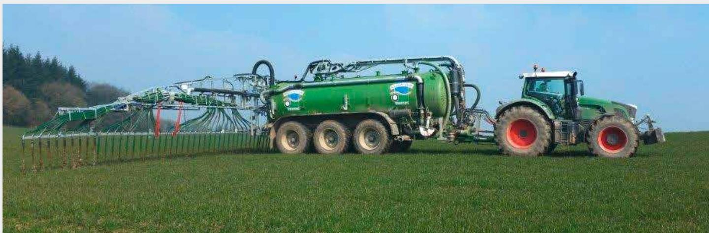
Tonne 25000 litres hybride avec rampe pendillards 24 metres
