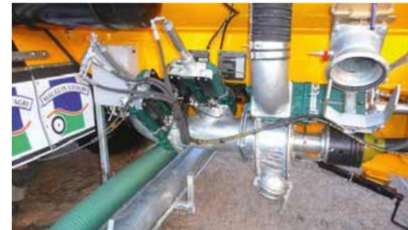
Système de vidange hybride qui couple un compresseur et une turbine d'épandage par entraînement mécanique. Ce système permet d'obtenir des performances d'épandage proche d'une tonne à lisier sans compresseur du type Typhon et l'utilisation d'une rampe à pendillards.
