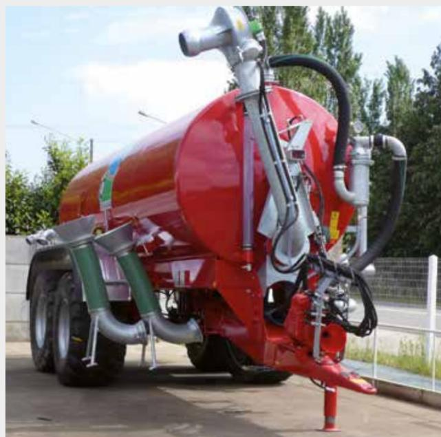
CYCLONE 14 000 L équipée d'un bras 1 élément avec accélérateur
