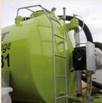
Trou d'homme avec échelle d'accès. Système de refroidissement pour compresseur.
