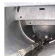
Mélangeur pneumatique et cloison anti-roulis
