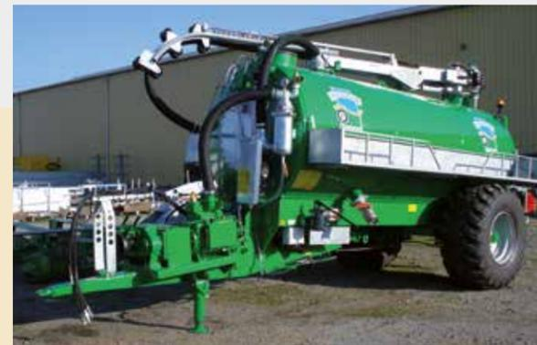
Hydrocureuse 11 000 L avec pompe HP 122 l/min et perche télescopique de pompage
