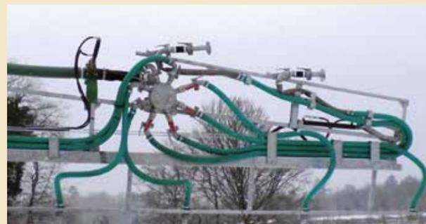
Diffuseur sphérique sur rampe 24 mètres. Pliage de la rampe sur elle-même pour le dernier tronçon 21/24 mètres
