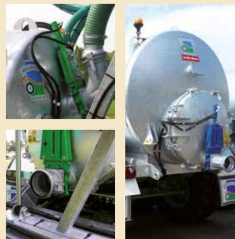
Sortie haute et basse de série et pré équipement pour l'attelage arrière
