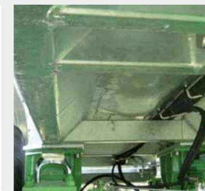
La gamme MISTRAL se caractérise par son châssis autoporteur **monocoque**. Il permet d'absorber les efforts du train roulant et également de monter un équipement arrière. Le prééquipement pour les rampes et enfouisseurs est disponible en option.
