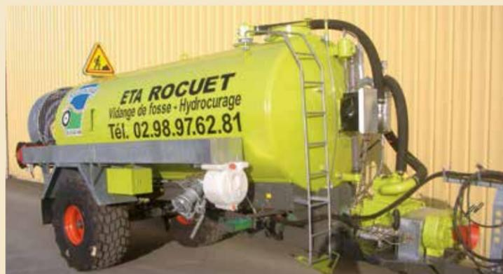
Hydrocureuse 11 000 L avec pompe HP 122 l/min
