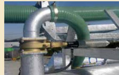
La mise à l'air libre se fait de manière automatique par une vanne hydraulique
