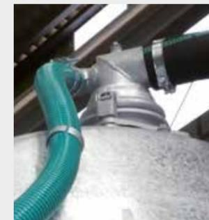
Soupape de sécurité double balle
