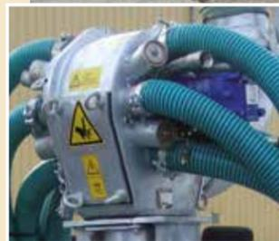
Enfouisseur 5,20 m - 13 dents équipé d'un hacheur répartiteur vertical avec piège à pierres et roues de jauge
