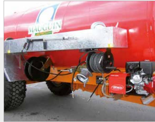
Groupe de nettoyage HP 18 l/min - 200 bar - moteur thermique 11 cv avec 20 mètres de tuyau 3/8" et lance à main
