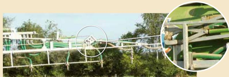
Système de pliage de la rampe à palettes 24 m et correction de dévers
