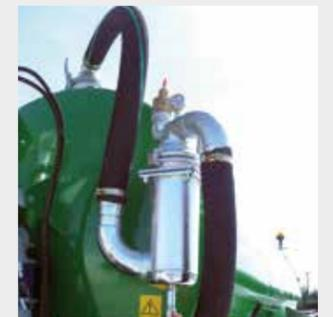
Sécurité compresseur avec manomètre de contrôle
