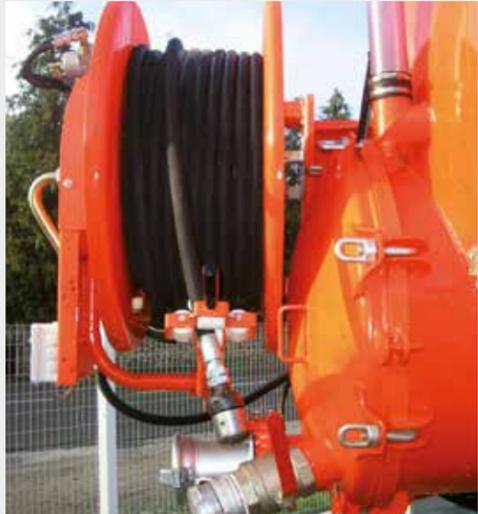
Enrouleur hydraulique avec 50 m de tuyau 3/4"
