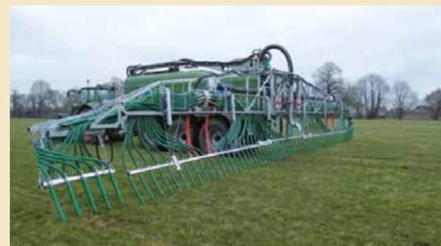
Rampe à pendillards 24 mètres sur TYPHON FG
