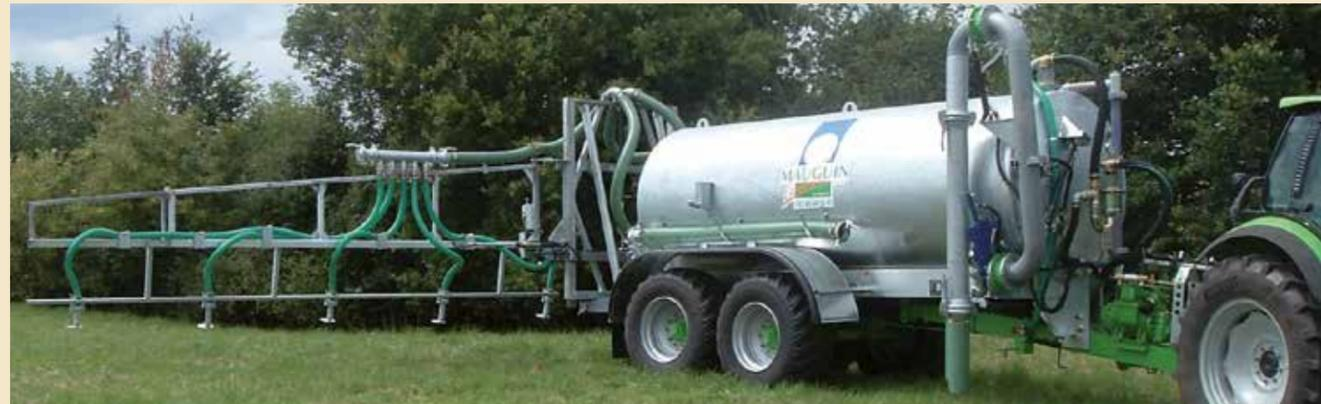
Rampe à palettes 15 mètres 10 jets sur CYCLONE 14 000 L avec bras de pompage 2 éléments
