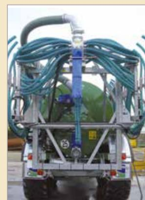
Rampe à pendillards sur bâti permettant le relevage et le dépliage de la rampe
