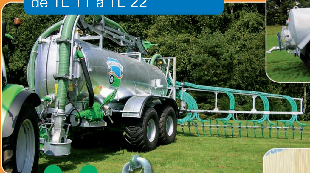
TL 15500 litres bras tourelle avec rampe pendillards
