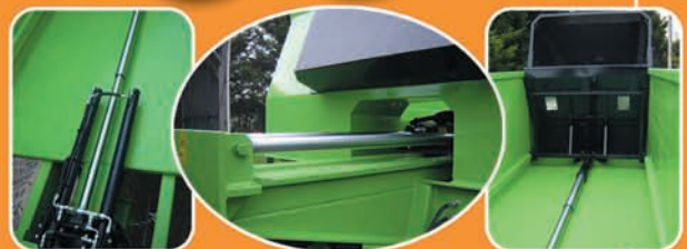
Principe de poussée du bouclier (3 verins)
