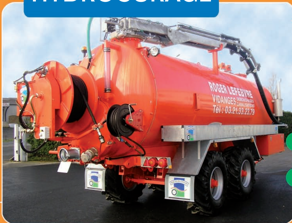
Ensemble tracté 18500 litres compartimenté eau/boue avec perche télescopique et enrouleur hyd. 1'
